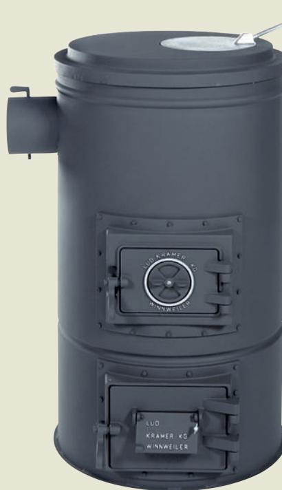
Über seinen optimierten Korpus und die große gusseiserne Abdeckplatte ist der **EWI-THERM-Dauerbrandofen GRA-A** in der Lage, seine Strahlungswärme mit sehr hoher Effektivität an den Raum abzugeben. Darüber hinaus garantiert die extrem lange Brenndauer zusammen mit der wärmespeichernden, langlebigen Schamottierung eine langanhaltende Wärmeabgabe. Der nach DIN 18890 geprüfte Dauerbrandofen eignet sich bestens zur Verbrennung von naturbelassenem Holz, Holz mit anhaftender Rinde und Briketts.
